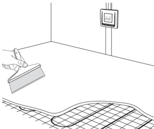
натуральный камень и т. д.) залейте нагревательный мат слоем плиточного клея толщиной 5–8 мм, не допуская образование пузырей, поднятия нагревательного мата.
