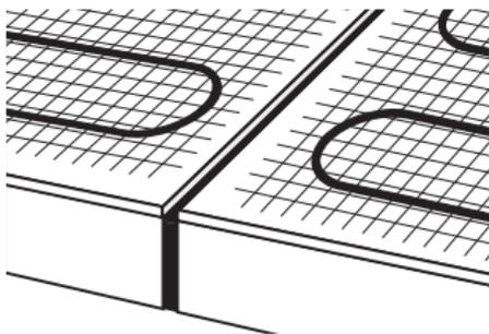
В случае, если здание имеет термокомпенсационные швы, нагревательные маты теплого пола «Теплолюкс» ProfiMat должны быть расположены так, чтобы исключалась всякая возможность прохождения кабеля нагревательного мата через шов.
