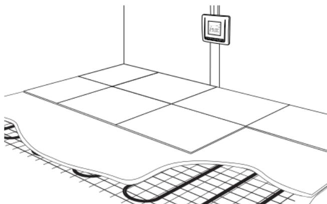
4.10. В случае использования в качестве декоративного напольного покрытия ламината, линолеума или ковровина схема укладки нагревательного мата будет следующей:
